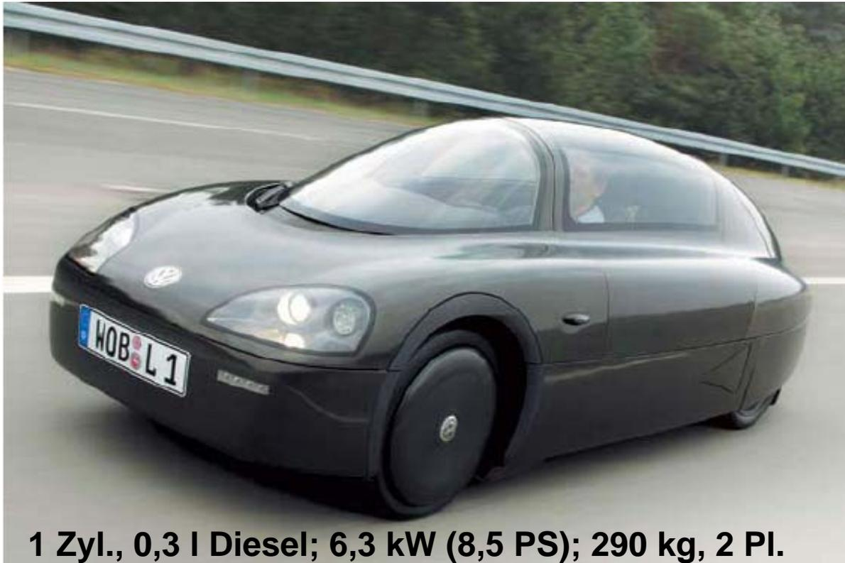
**1 Zyl., 0,3 l Diesel; 6,3 kW (8,5 PS); 290 kg, 2 Pl.**
