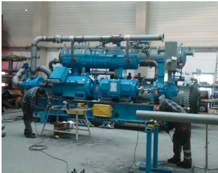
Wärmepumpe Marienhütte in Fertigstellung (01/2016); Quelle: Energie Graz
